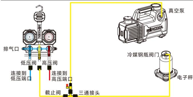
在与系统连接之前, 请查看压力表的指针是否在零位, 如若没有, 请使用校准针, 通过顶部进行放气, 校准至零位即可。
