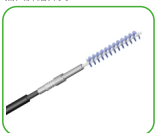
找到合适的毛刷并连接软轴
